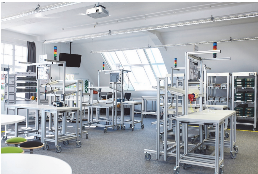
Abbildung 7: Manuelle Montagelinie in der Digital Lean Learning Factory, Quelle: Eigene Darstellung
