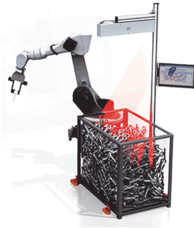
Abbildung 56: Bin Picking zur Handhabung ungeordneter Teile, Quelle: Eigene Darstellung
