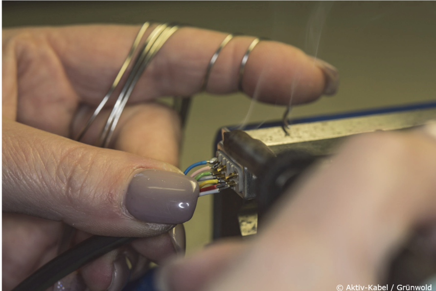
Abbildung 2: Beispiel eines typischen Wertschöpfungsprozesses (Lötarbeit) bei Aktiv-Kabel, Quelle: Eigene Darstellung
